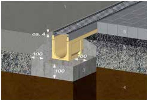
Fahrbahnbeton bzw. Betonplatten oder Pflasterbedeckung
