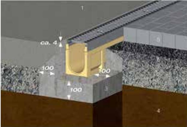
Fahrbahnbeton bzw. Betonplatten oder Pflasterbedeckung
